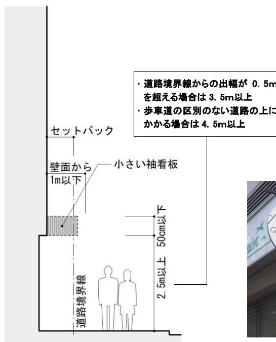
図3 : 上下寸法50cm×幅1m以下の袖看板
